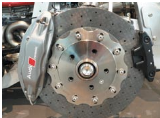
Brzdové destičky R8 jsou vyrobeny ze speciálních keramických materiálů zaručujících vysoký brzdný účinek i při rychlostech nad 300 km/hod.
