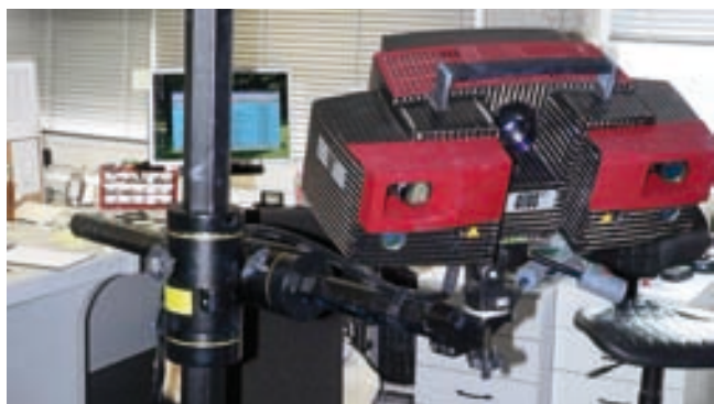
Mobilní bezdotykový (optický) 3D skener
