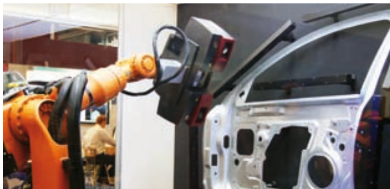
3D optický skener ATOS Triple Scan s revolučním modrým světlem (MSV 2011, Brno)
