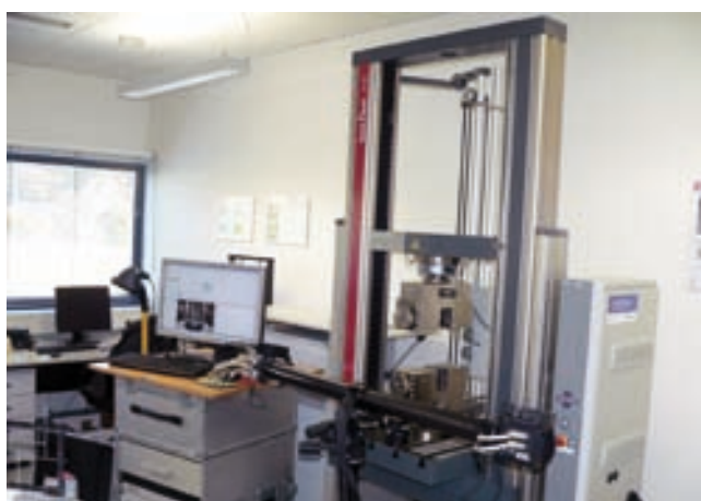
Aramis – bezkontaktní měřicí systém firmy GOM
