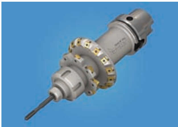
Prořezávací fréza s vrtákem a destičkami pro čelní zarovnání
