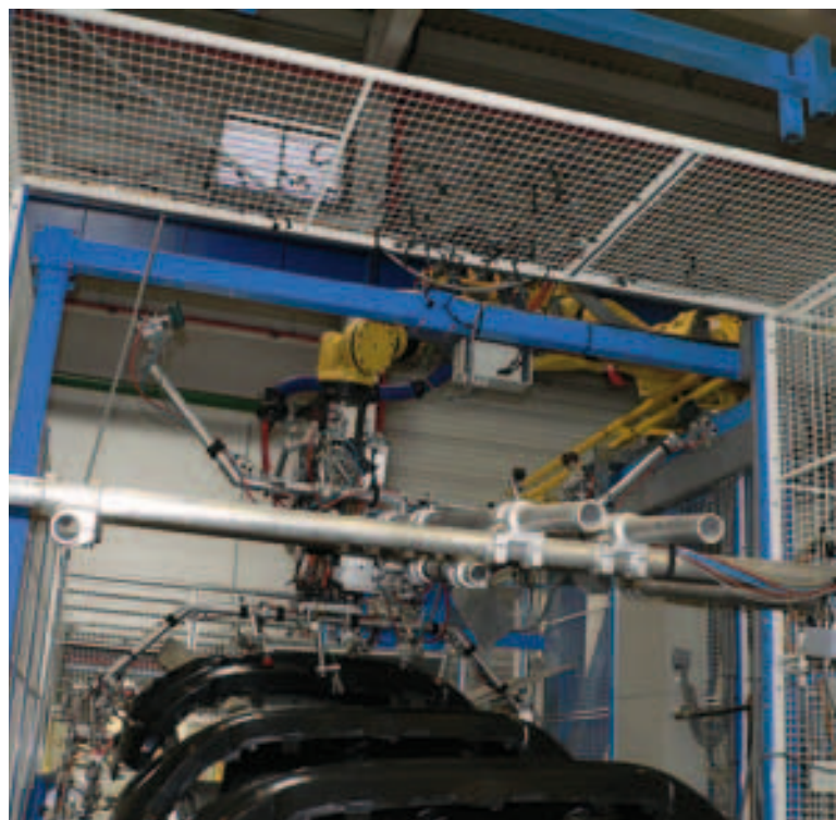
Robot FANUC pokládá vylisek – nárazník na pásový dopravník
