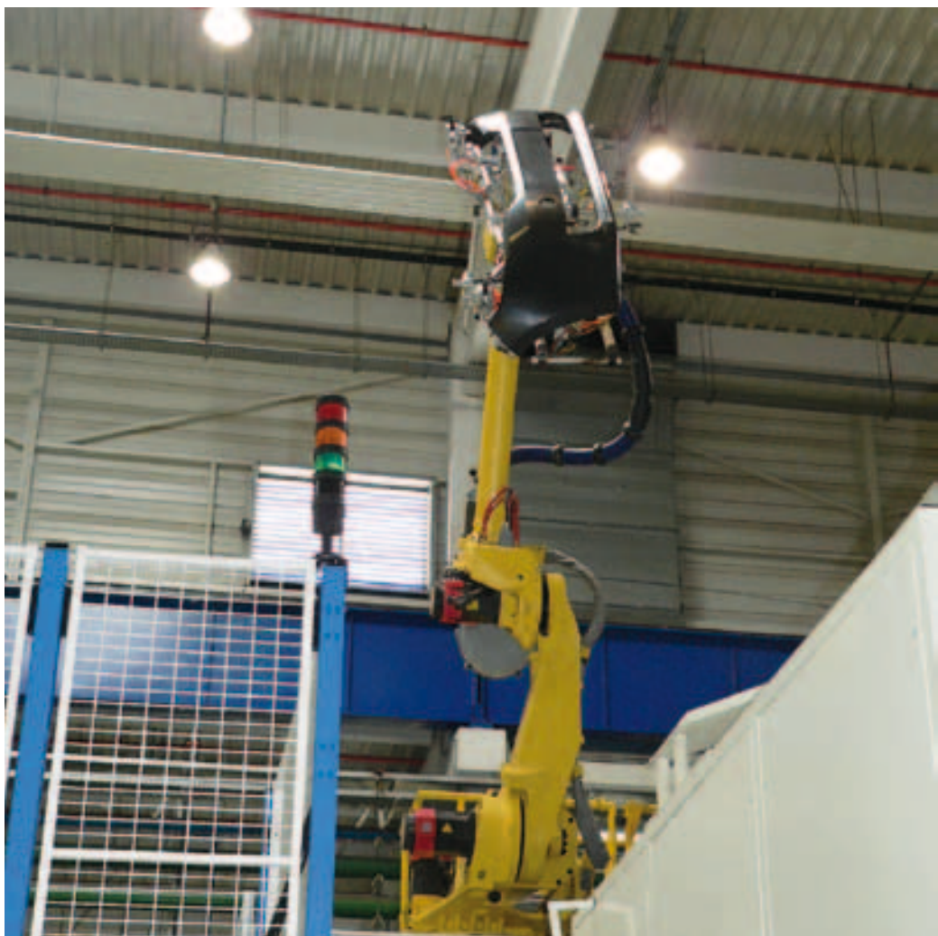
Robot FANUC po odebrání výlisku – nárazníku z formy, kdy následují další operace
