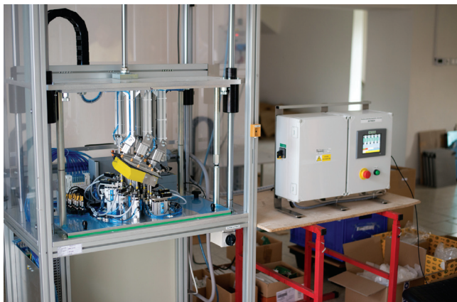
Jednouúčelový stroj pro 3D měření rozměrů tvarově složitých výrobků.
