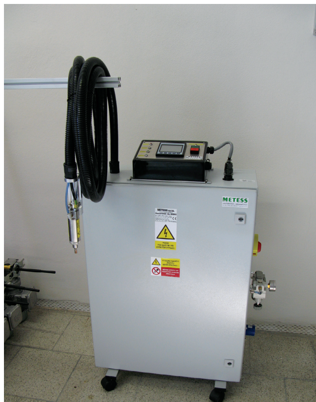
Zařízení pro aktivaci povrchu atmosférickou plazmou.
