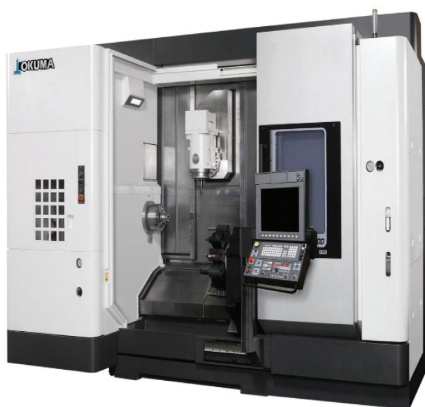
OKUMA Multus U4000 (vysoce výkonné frézovací-soustružnické centrum, 2 vřetena, dolní zásobník nástrojů, horní frézovací hlava)
