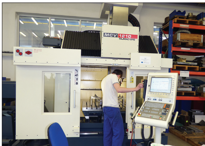
Portálové obráběcí centrum se širokým uplatněním při obrábění složitých prostorových tvarů ve třech nebo pěti osách
