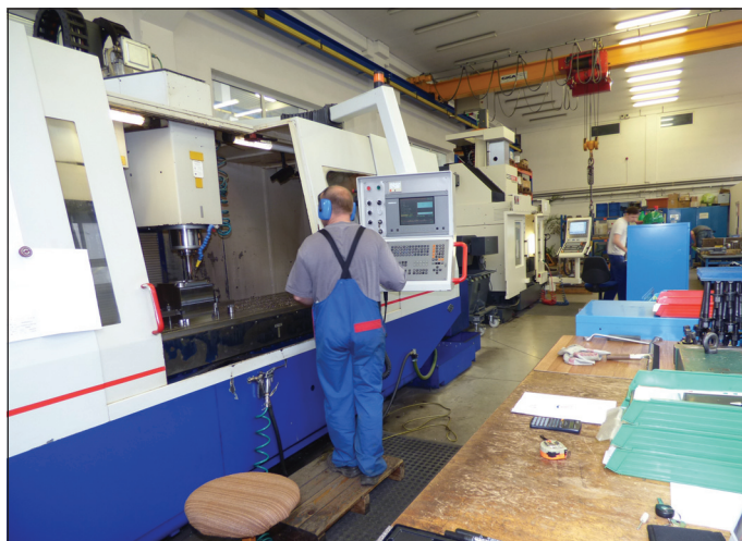
MCFV 2080 – vysoce produktivní vertikální CNC centrum pro třískové obrábění
