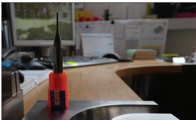
Frézy řady 30.6261, 30.6264 s výdrží cca 12 hodin. Na obrázku po skončení výrobní operace.
