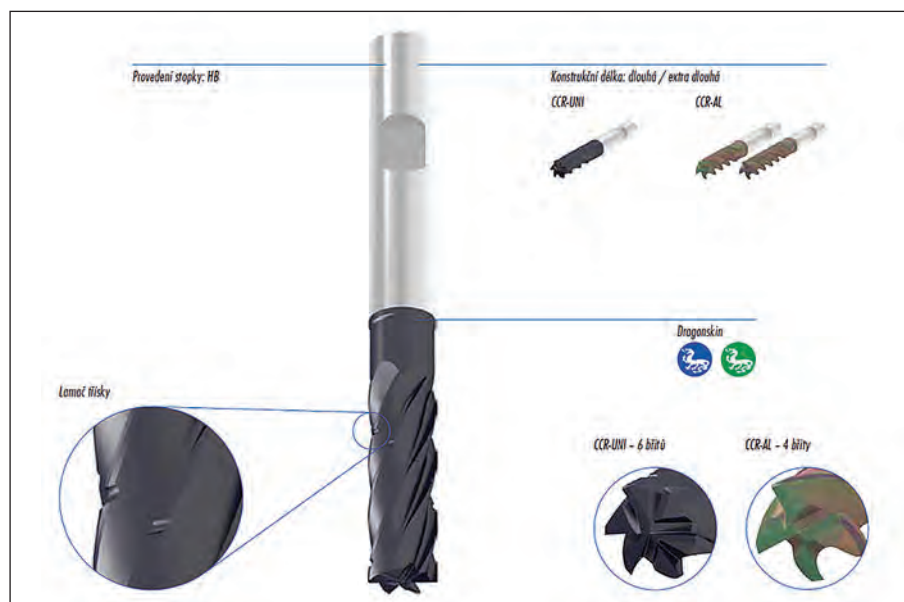
WNT nabízí 2 typy CCR fréz pro trochoidní frézování. Geometrie CCR-UNI se 6 břitů pro univerzální použití a geometrii CCR-AL se 4 břitů pro frézování neželezných kovů, zejména slitin hliníku. Užžitnou hodnotu zvyšují inovativní povlaky Dragonskin WNT
