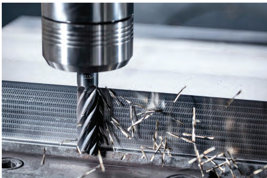
Specifickou vlastností CCR fréz je speciální lamač třísek, který je součástí geometrie břítu a umožní obrábění do hloubek až 4xD
