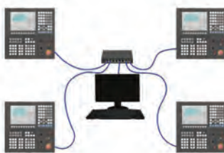
Na obrázku je schéma zapojení několika systémů Active Edge do sítě ActiveNet
