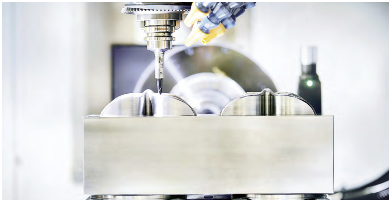
Přesné upínací nástroje SCHUNK TRIBOS-Mini a TRIBOS-RM se stopkami HSK-E 25, HSK-E 32 a HSK-F 32 jsou k dispozici i ultra jemně vyvážené s kvalitou G 0,3 při 60 000 min -1
