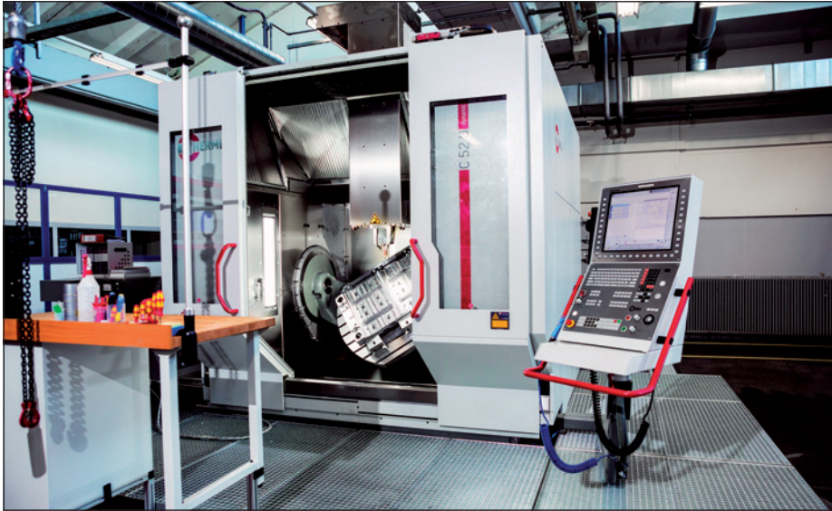
Největší 5osé vysokovýkonné CNC obráběcí centrum C 52 U v nástrojárně firmy Hirschmann Automotive GmbH v závodu A-Rankweil pro kompletní 5osé/5stranné obrábění obrobků do průměru 1000 mm a výšky 810 mm
