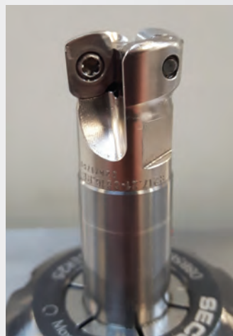
Flowserve – nástroj HF2 o průměru 16 mm se dvěma břitovými destičkami
